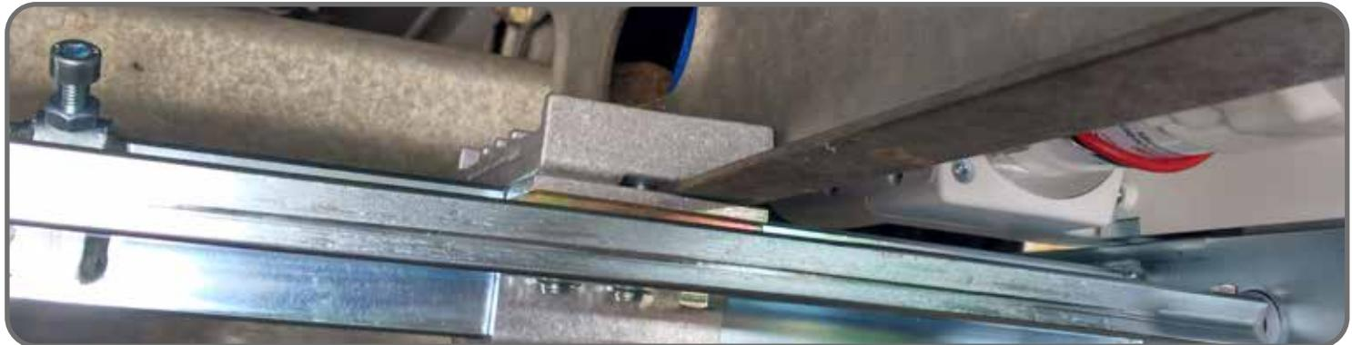
Um die Klemmplatten montieren zu können muss das Chassis aus einem Stück bestehen. Das nennen wir ein Standardchassis wie hier abgebildet:
